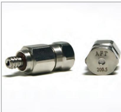
Axial-Hohlkegeldüse aus Edelstahl mit Hochleistungskeramik. Innenliegendes Ventil, welches das Vor- und Nachtropfen verhindert. Die Sprühkeramik ist Verkalkungs- und Schmutzunanfälliger. Zudem ist das Sprühbild und die Tröpfchen homogener als bei Edelstahldüsen.
